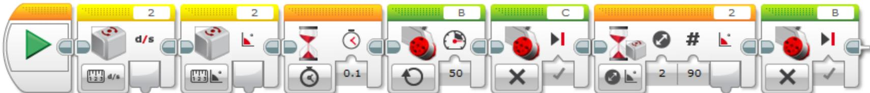
**PASSO 1: VOCÊ PRECISA INICIAR O GYRO:** Nós temos os dois blocos aqui porque a leitura do sensor Gyro continua mesmo quando o robô está parado. Ao ler a taxa do Gyro e depois o ângulo faz com que o Gyro seja recalibrado. Certifique-se de rodar estes blocos com o robô parado.
